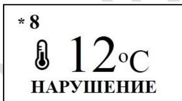
Рис. 6 – Отображается максимальное значение температуры, текущая температура и наличие нарушения
